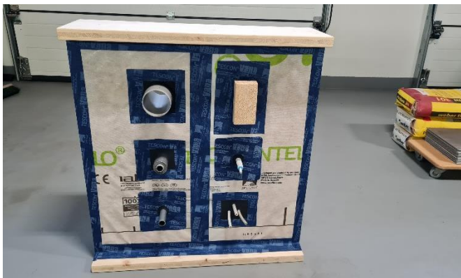
Bild: Fertig abgedichteter Prüfkörper
